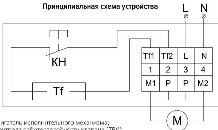
**М** – электродвигатель исполнительного механизма;
